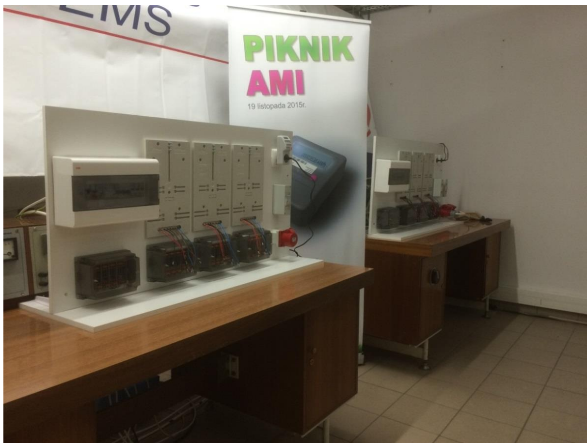
Rys. 7.1. Stanowisko pomiarowe w ramach eksperymentu porównawczego efektywności komunikacji liczników inteligentnych w ramach Pikniku AMI
