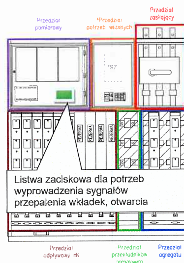
Rozdzielnica nN wewnątrz
