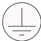
Rysunek nr 9.4.9. Symbol uziemienia
